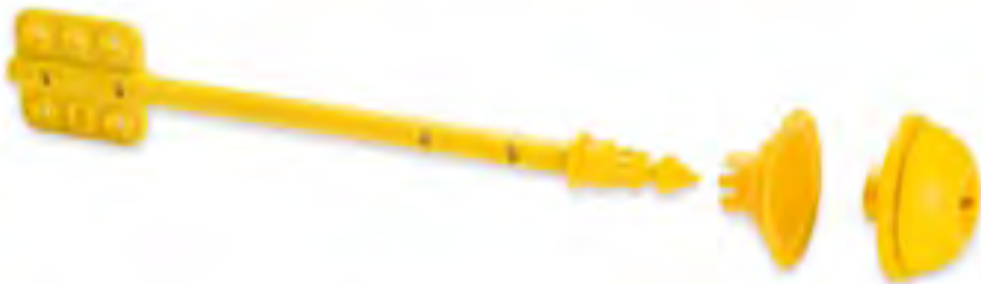
Suspente Intégra 2 pour une étanchéité à l'air parfaite Permet de fixer la membrane d'étanchéité à l'air entre l'isolant et la ferrure métallique, sans dégrader ses performances, conformément aux exigences du CPT 3560 (cf p. 6).
